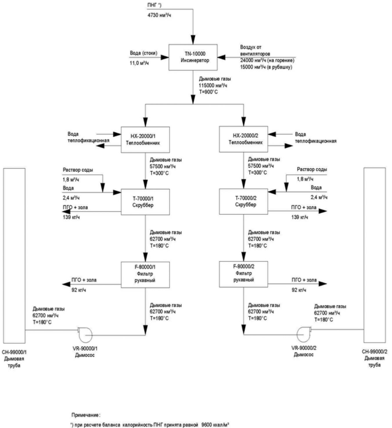
Рис. 4.1. Принципиальная схема термического окисления газов с указанием материального баланса (на примере обработки сероводородсодержащего ПНГ в Установке максимальной производительности)
